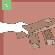
1. Das Holz locker in den Brennraum schichten.
