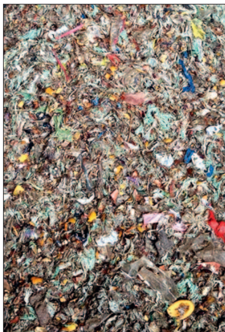
Kunststoffreste nach der Aufbereitung
