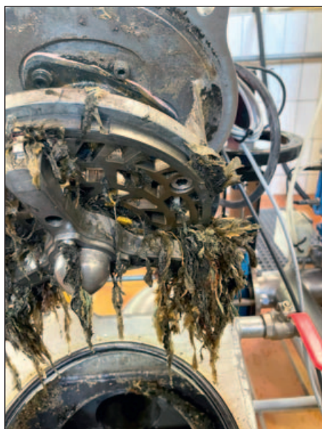
Turbinenprobleme durch Säcke aus Maisstärke
